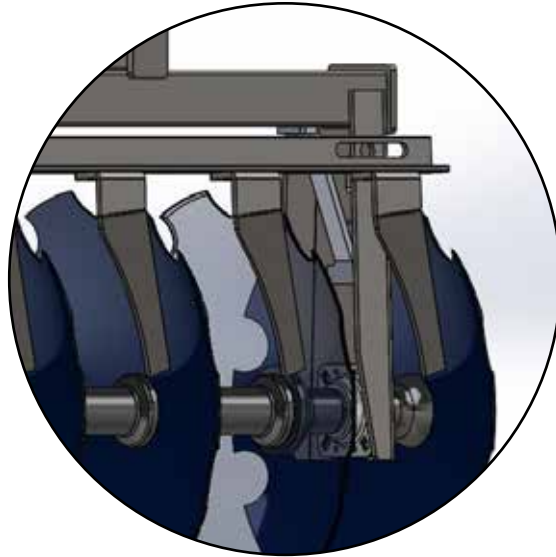
Imagen 1.1 - Detalle para posicionamiento de rodamiento y pierna
